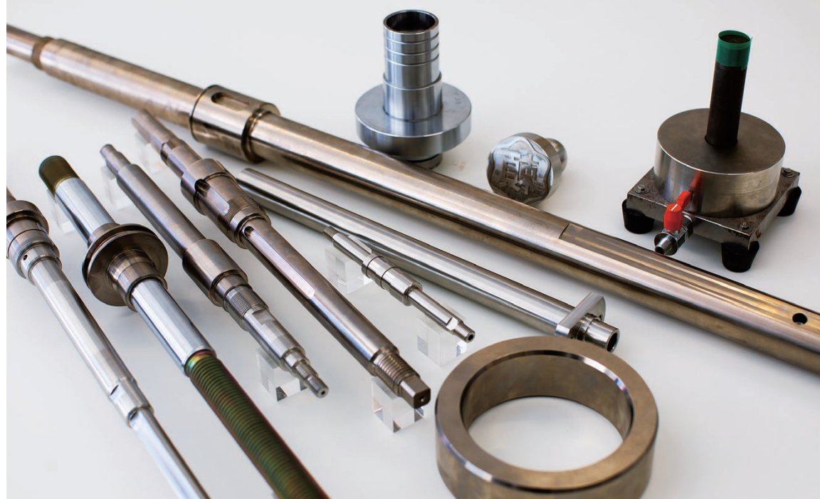
顧客の要望に合わせて作る精密シャフト。太さや長さ、形、材質などが異なるシャフトを、毎月200種類以上、年間では1000種類以上製造している。手前の円柱形の部品は、精密嵌合部品のカラー。
