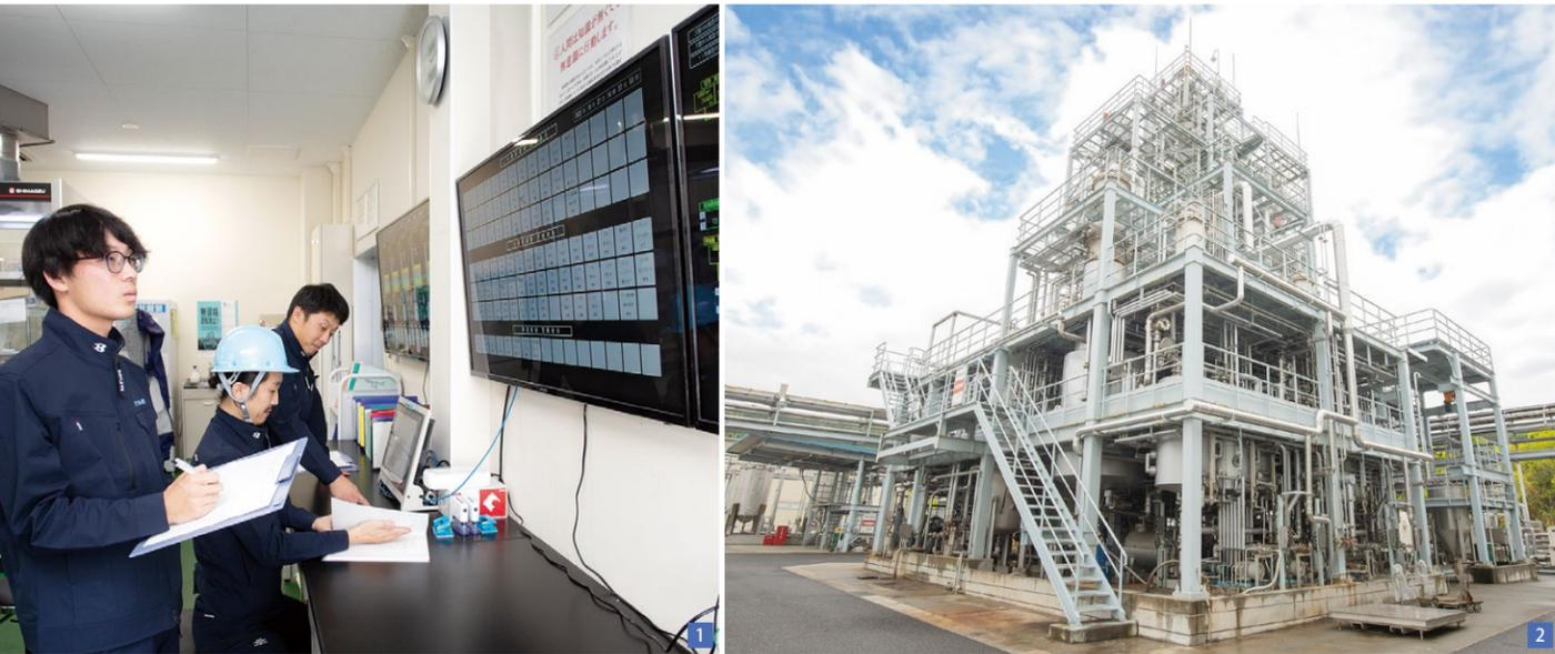
1.高度な蒸留技術と分析技術を駆使し、多種多様な製品ニーズに応える同社。工場ではオペレーターが24時間・3交代制で蒸留の状態をモニタリングし、適切なタイミングで工程を切り替えている 2.2006年開設の岡山工場では蒸留塔11基が稼働。50mlから数100tまでのあらゆるスケールに対応し、沸点が近く分離しにくいものや熱に弱いものなども蒸留が可能に。精製後の微量な不純物を管理・保証できる微量分析技術を持つことも大きな強み
