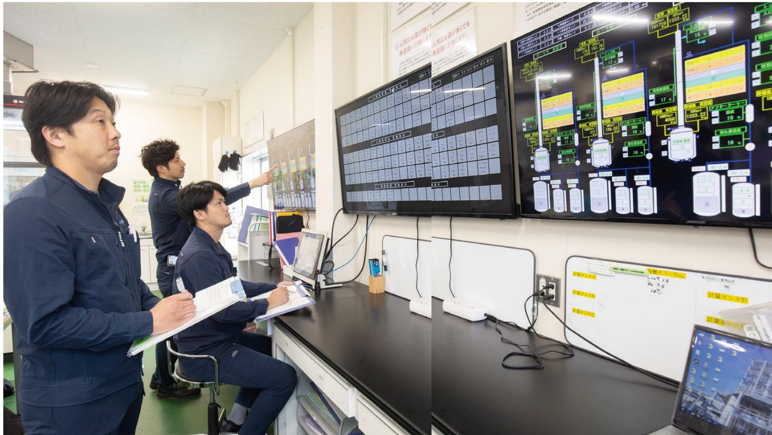
オペレーターが蒸留の状態をモニタリングし、適切なタイミングで工程を切り替える。異常事態が発生した場合には、長年培った経験をもとに迅速に対応
