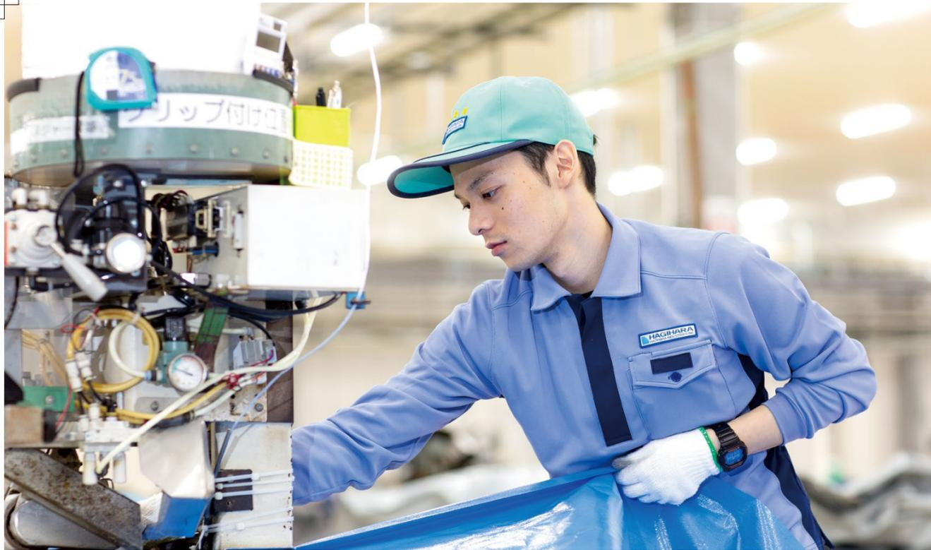
ブルーシートを高温の熱で貼り合わせる「熱溶着」の工程を担うスタッフ。笠岡工場では小ロットの製品や特注品もより効率的に生産できる
